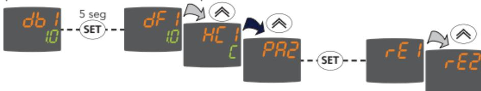
Pulsando la tecla **set** cuando se halle en la carpeta deseada ("rE2" en el ejemplo), se visualizará el primer parámetro de la misma. Seleccione el parámetro deseado mediante las teclas **▲** y **▼**. Modifique el valor (visualizado en la segunda línea) mediante las teclas **▲** y **▼** y pulse las teclas **set** o **fnc** para memorizar el nuevo valor.
