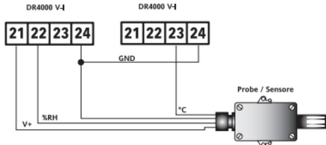
**ATTENTION ! :** la couleur des fils est indicative. Contrôler sur l'étiquette de la sonde le schéma de connexion correct.
