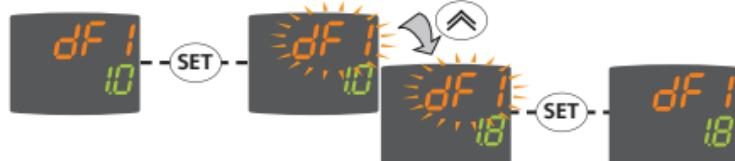
**REMARQUE :** il est conseillé d'éteindre et de rallumer l'instrument chaque fois que l'on modifie la configuration des paramètres pour éviter tout dysfonctionnement au niveau de la configuration et/ou des temporisations en cours.
