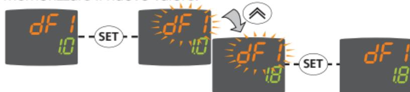
**NOTA:** E' consigliato spegnere e riaccendere lo strumento ogni qualvolta si modifichi la configurazione dei parametri per prevenire malfunzionamenti sulla configurazione e/o temporizzazioni in corso.
