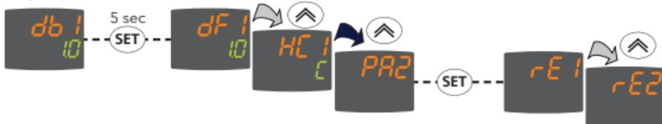
Premendo il tasto **set** in corrispondenza della cartella desiderata ("rE2" nell'esempio), verrà visualizzato il primo parametro contenuto. Selezionare il parametro desiderato mediante i tasti **▲** e **▼**. Modificarne il valore (visualizzato sulla seconda riga) mediante i tasti **▲** e **▼** e premere i tasti **set** o **fnc** per memorizzare il nuovo valore.
