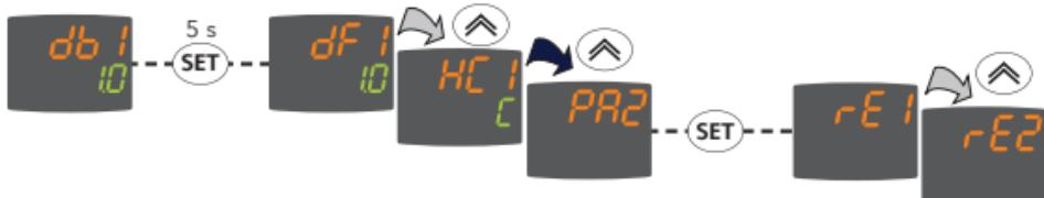
Appuyer sur la touche **set** correspondant au répertoire souhaité (« rE2 » dans l'exemple) pour visualiser le premier paramètre qu'il contient. Sélectionner le paramètre souhaité à l'aide des touches **▲** et **▼**. En modifier la valeur (visualisée sur la deuxième ligne) à l'aide des touches **▲** et **▼** et appuyer sur les touches **set** ou **fnc** pour mémoriser la nouvelle valeur.
