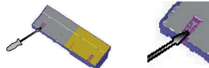
FIG 2 Spring Docking Devices-Dispositivi di aggancio a molla
