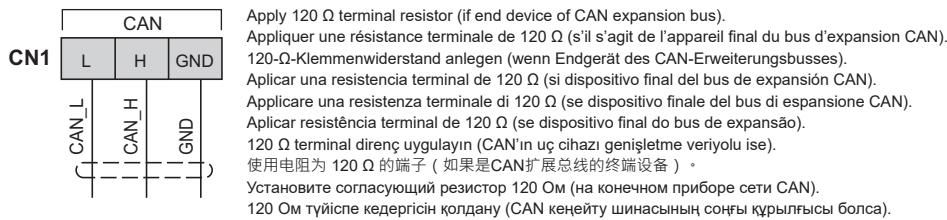
**CAN connection example / Exemple de connexion CAN / CAN-Anschlussbeispiel / Ejemplo de conexión CAN**
