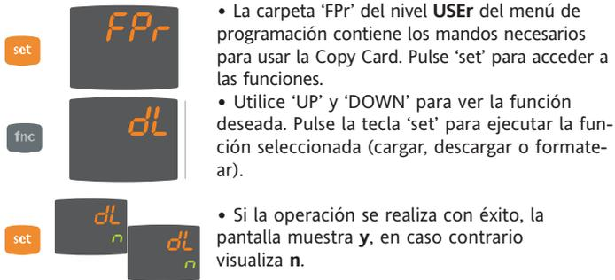
**Descarga desde "reset":** Conecte la llave con el instrumento apagado. Al encenderse el instrumento se cargan en el mismo los parámetros de programación; terminado el chequeo de pilotos, el display mostrará durante un período de unos 5 segundos:
