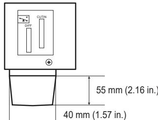
Sensor size / Dimensione sensore / Tamaño del sensor/ Sensorgroße / Taille du capteur / Размер сенсора
