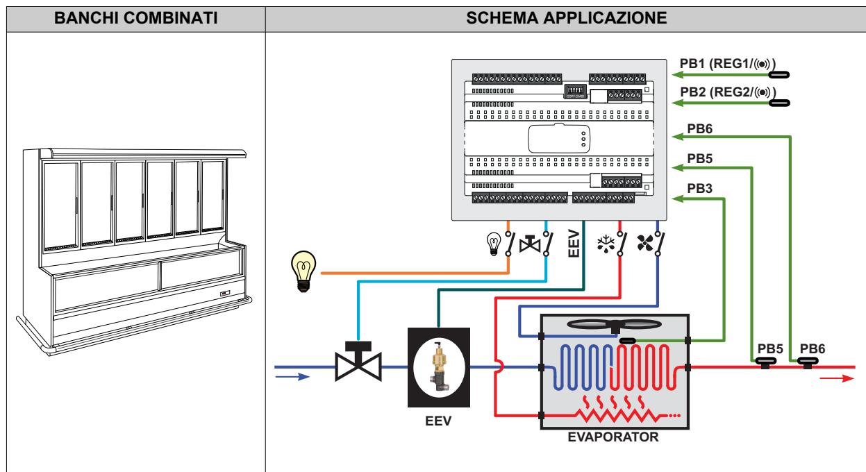
Legenda: REG1/2 = Regolatore 1/2; EEV = Valvola di espansione elettronica; Evaporator = Evaporatore.
