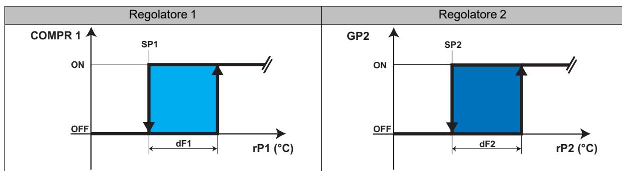
Il primo regolatore attua l'uscita **COMPR 1**, la quale dipende dalle grandezze e parametri indicati nello schema, oltre che dalle tempistiche di sicurezza compressore.
