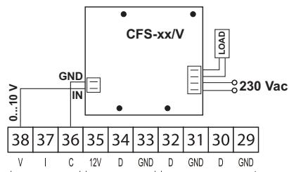
**Nota:** I moduli CFS-xx/I regolano la tensione di un carico e in ingresso hanno una I = 4...20 mA.
