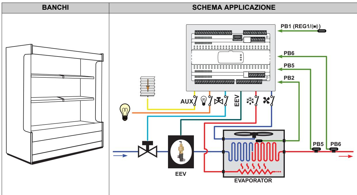
Legenda: **REG1** = Regolatore 1; **EEV** = Valvola di espansione elettronica; **Evaporator** = Evaporatore.
