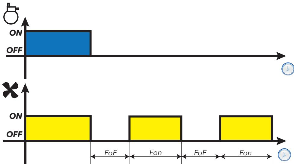
Schema di regolazione duty cycle notte (Night) con compressore spento
