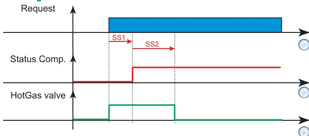
**Legenda:** **Request** = Richiesta raffreddamento; **Status Comp.** = Stato compressore; **HotGas valve** = Valvola Gas Caldo.
