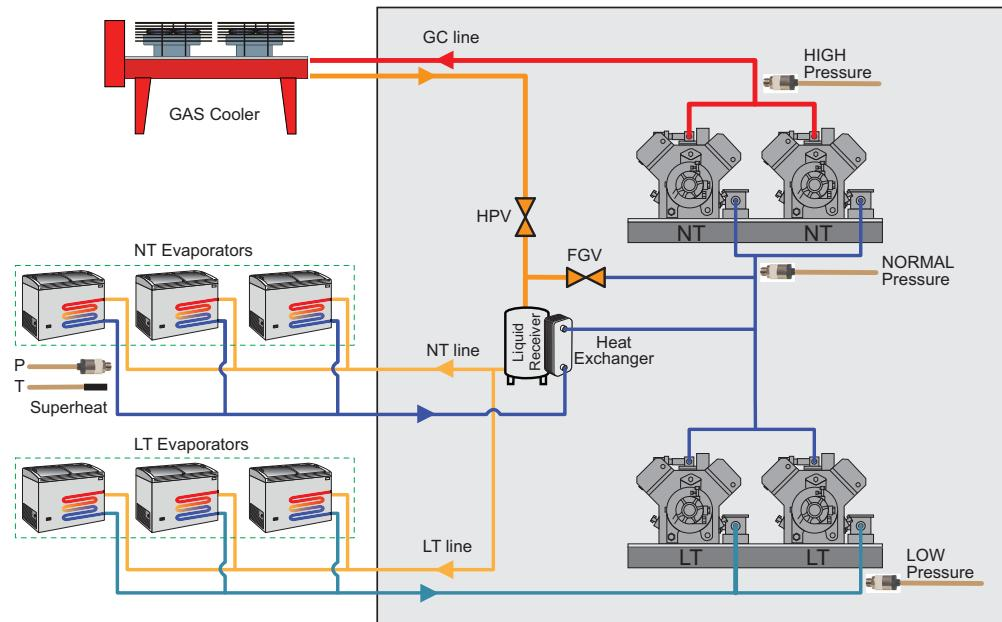
Esempio 2: Scambiatore rigenerativo in serie al Gas Cooler.
