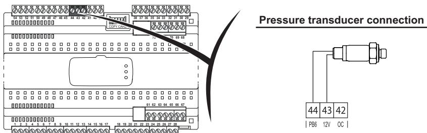
**Legenda: Pressure transducer connection** = Connessione trasduttore di Pressione
