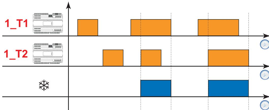
**Legenda:** **1\_T1** rappresenta l'andamento della sonda impostata come 1° termostato e **1\_T2** rappresenta l'andamento della sonda impostata come 2° termostato.
