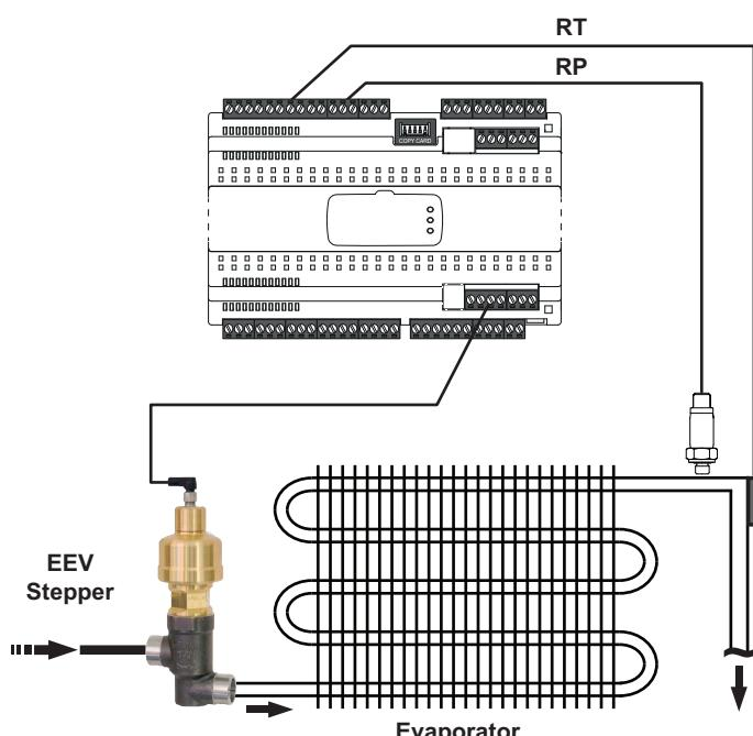
**Legenda:** **RT** = Temperatura uscita evaporatore; **RP** = Pressione di evaporazione; **EEV Stepper** = Valvola Stepper; **Evaporator** = Evaporatore.
