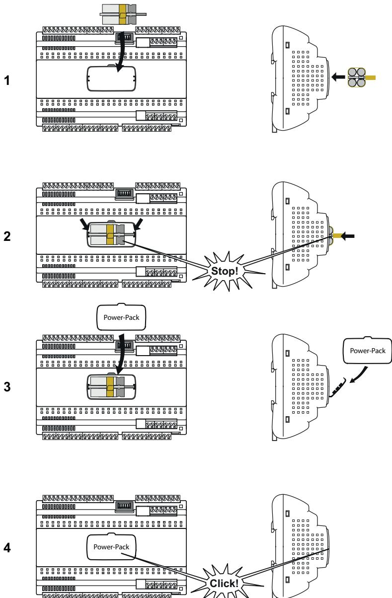
**Nota:** Qualora il coperchio del **Power-Pack** non si chiuda completamente, verificare il corretto inserimento del **Power-Pack** all'interno delle guide.
