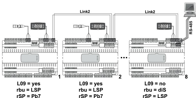
La Link2 provvederà automaticamente a condividere uno dei due valori disponibili (il primo valore ricevuto). L'altro dispositivo, dotato di trasduttore di pressione, non utilizzerà il valore condiviso bensì quello locale, a meno che non sia in errore, in qual caso utilizzerà il valore condiviso.
