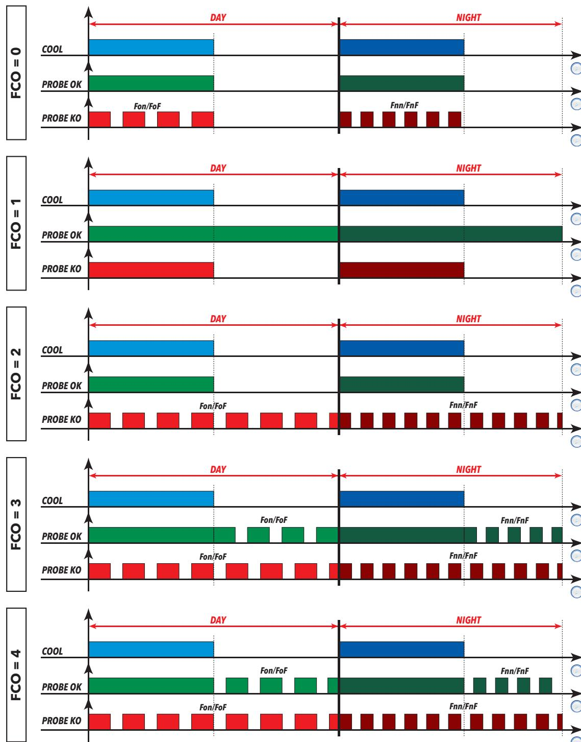
**Legenda:** **DAY** = Giorno; **NIGHT** = Notte; **COOL** = Raffreddamento; **Probe OK** = Funzionamento ventole con la sonda presente e funzionante; **Probe KO** = Funzionamento ventole con la sonda presente ma in errore.
