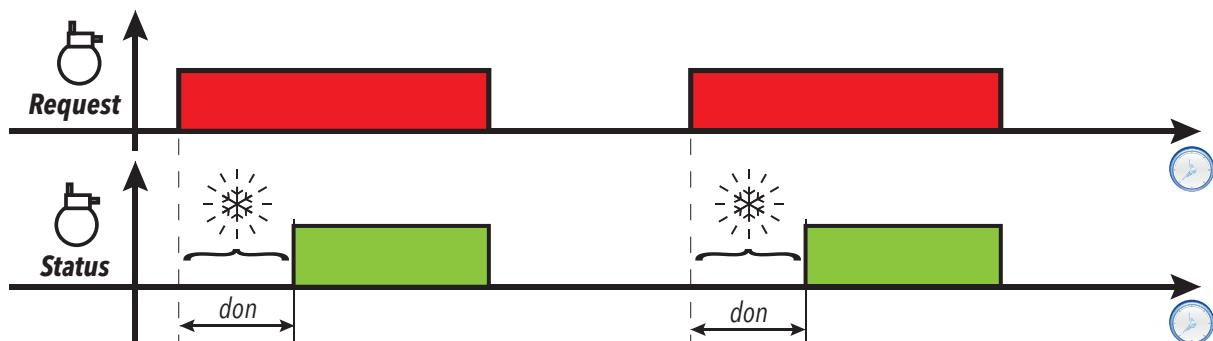
**Legenda:** PO = Accensione controllore; = Icona compressore lampeggiante; **Request** = Richiesta attivazione compressore; **Status** = Stato compressore (ON/OFF).
