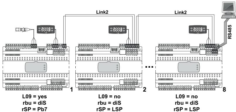
Aggiornare la sonda di saturazione inviata dal sistema di supervisione con un periodo inferiore a 3 minuti altrimenti la sonda verrà considerata in errore.
