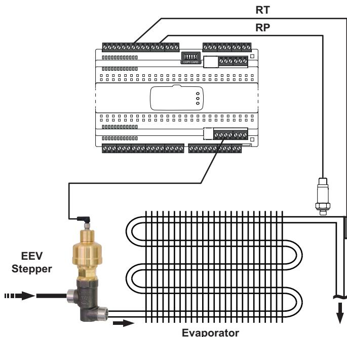
**Legenda:** **RT** = Temperatura refrigerante; **RP** = Pressione refrigerante; **EEV Stepper** = Valvola stepper; **Evaporator** = Evaporatore.
