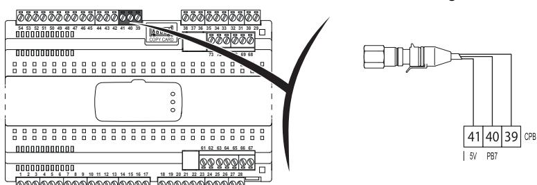
Impostare il parametro **rSP= Pb7** per utilizzare l'ingresso raziometrico (Pb7) come sonda di saturazione. Impostare mediante il parametro **trA** uno dei trasduttori raziometrici elencati:
