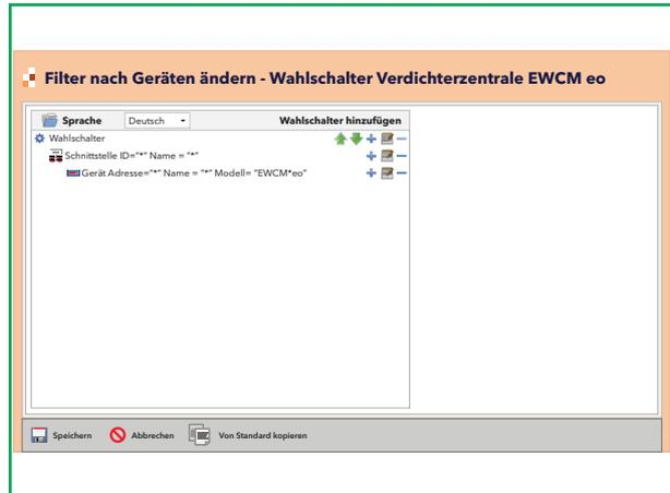
Nach Berechnung von SaturationSensorBackup schreibt der Algorithmus den resultierenden Fernwert SaturationSensorBackup auf alle mit dem Wahlschalter ausgewählten Theken **RTX**. Im Wert des Backup-Fühlers ist der Offset enthalten.
