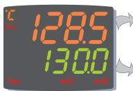
Process value (PV): Anzeige von: Prozesswert, Label der Parameter, der Alarme und Funktionen.
