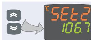
③ Usando i tasti 'UP' e 'DOWN' è possibile modificare il valore del setpoint visualizzato sul display SV.
