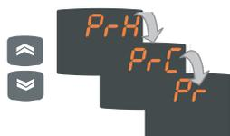
Premendo il tasto 'set' in corrispondenza della label Pid viene visualizzata la label della prima sotto cartella PrH. E' possibile scorrere le sottocartelle mediante i tasti UP e DOWN.
