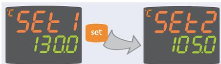
② Sul display PV viene visualizzata la label SET1, mentre sul display SV il valore corrente del Setpoint. Premendo ancora il tasto 'set' verrà visualizzato con le stesse modalità il Setpoint 2. (se H01=4 o 5)
