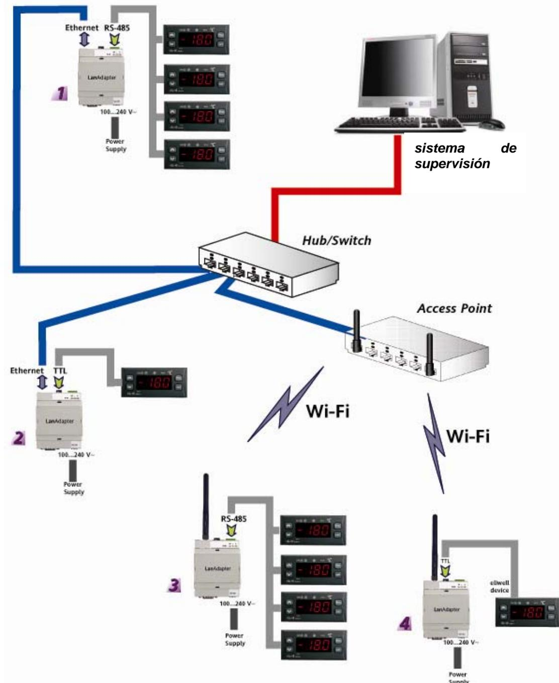
La red está compuesta por un sistema de supervisión instalado en un PC de una red LAN.
