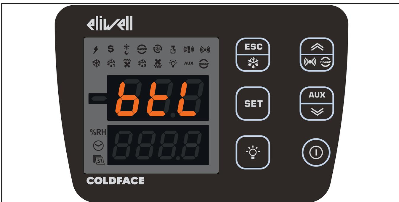
Модели **RCN**.....: когда модуль НАССР (НАССР Module) подсоединен, и активировано соединение Bluetooth с приложением Eliwell Air, этикетка btL появляется на ВЕРХНЕМ ДИСПЛЕЕ, а НИЖНИЙ ДИСПЛЕЙ и символы гаснут.
