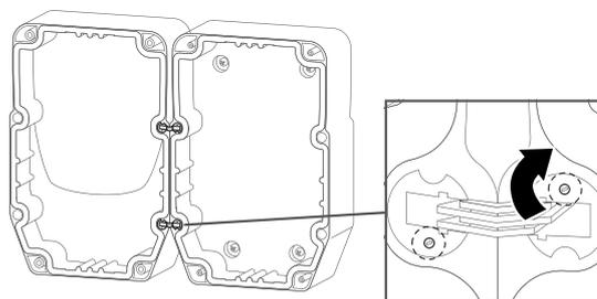
8) Закройте крышку и зафиксируйте ее в этом положении поставляемыми шурупами.
