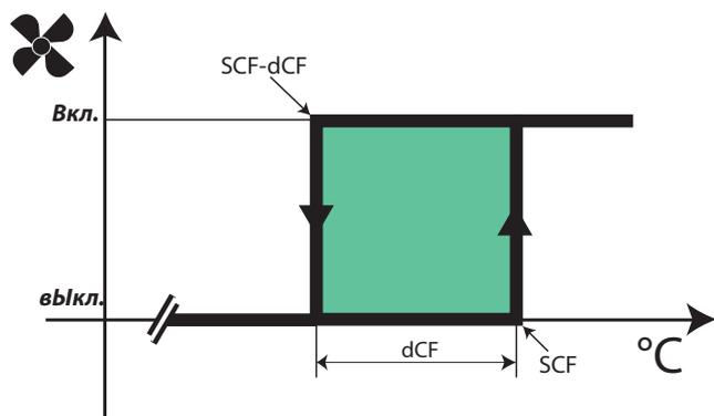
Если датчика **Pb3** нет или он неисправен (авария **E3**), то регулятор будет постоянно Включен исключая цикл Разморозки.
