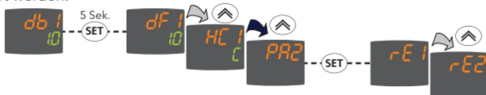
Durch Drücken der Taste **set** auf der gewählten Registerkarte ("rE2" im Beispiel) wird der erste enthaltene Parameter eingeblendet. Den gewünschten Parameter mit den Tasten **↕** und **↕** wählen. Den (auf der zweiten Zeile) angezeigten Wert mit den Tasten **↕** und **↕** ändern und den neuen Wert mit den Tasten **set** oder **fnc** übernehmen.
