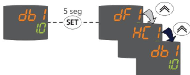
Seleccione el parámetro deseado mediante las teclas **↕** y **↕**. Para modificar el valor, pulse la tecla **set**. La etiqueta del parámetro empezará a parpadear. Modifique el valor (visualizado en la segunda línea) con las teclas **↕** y **↕** y pulse las teclas **set** o **fnc** para memorizar el nuevo valor.
