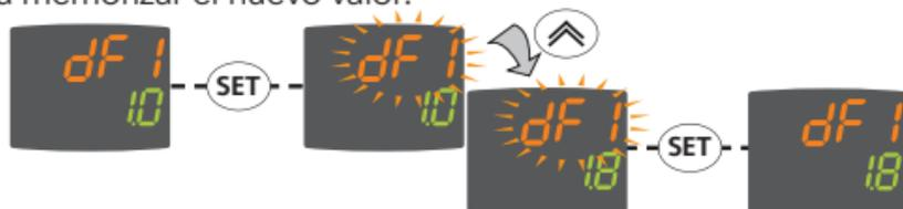
**NOTA:** Se aconseja apagar y volver a encender el instrumento siempre que se modifique la configuración de los parámetros para evitar un mal funcionamiento en la configuración y/o en las temporizaciones en curso.
