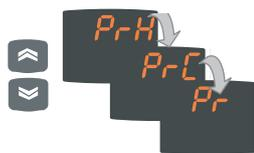
Premendo il tasto 'set' in corrispondenza della label **Pid** viene visualizzata la label della prima sotto cartella **PrH**. E' possibile scorrere le sottocartelle mediante i tasti UP e DOWN.
