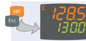
④ Premendo il tasto 'set', o 'fnc', oppure allo scadere del tempo di time out (15 sec), il nuovo valore verrà memorizzato e il display ritornerà alla visualizzazione iniziale
