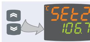
③ Usando i tasti 'UP' e 'DOWN' è possibile modificare il valore del setpoint visualizzato sul display **SV**.
