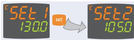
② Sul display **PV** viene visualizzata la label **SET1**, mentre sul display **SV** il valore corrente del Setpoint. Premendo ancora il tasto 'set' verrà visualizzato con le stesse modalità il Setpoint 2.
