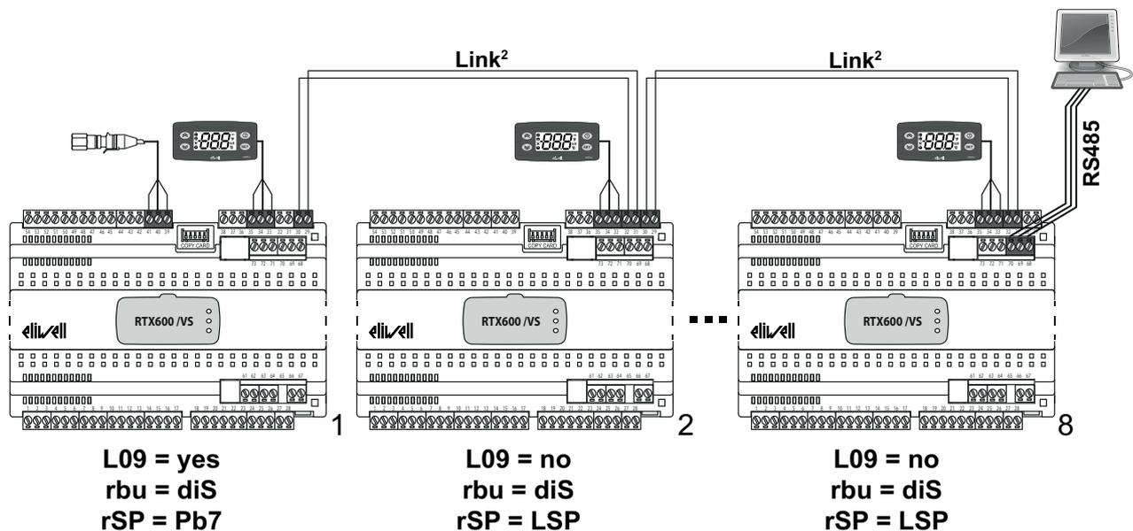
Aggiornare la sonda di saturazione inviata dal sistema di supervisione con un periodo inferiore a 3 minuti altrimenti la sonda verrà considerata in errore. In caso di sonda in errore, tutti i dispositivi regoleranno secondo quanto configurato con i parametri di errore sonda.
