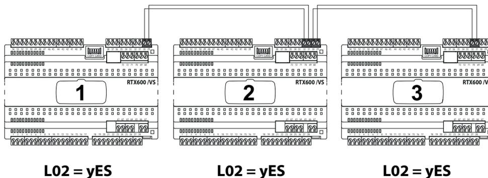
**NOTA:** Quando il parametro **L02 = yES**, se viene cambiato il valore del setpoint in uno qualsiasi dei dispositivi, lo stesso valore verrà impostato anche in tutti gli altri dispositivi della rete. Qualora uno dei dispositivi venga staccato dalla rete o perda la comunicazione dopo un cambio del valore di setpoint, esso continuerà a utilizzare il nuovo valore impostato.
