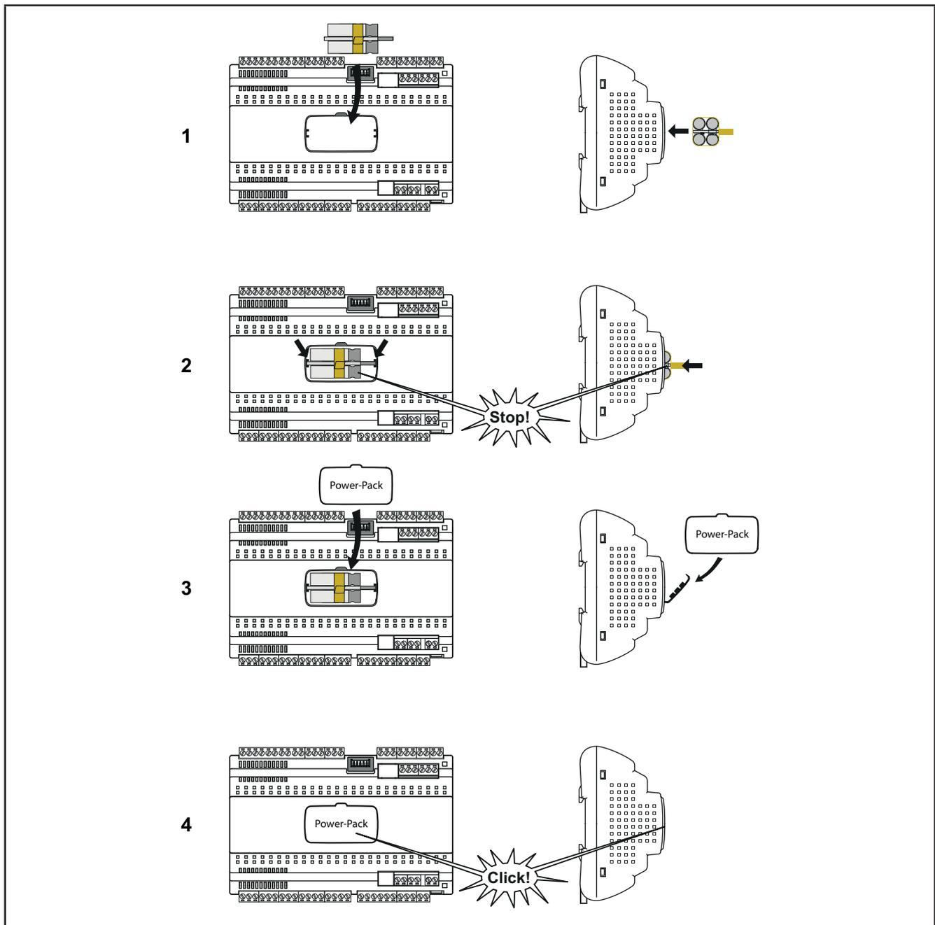
Fig. 26. Montaggio del Power-Pack
