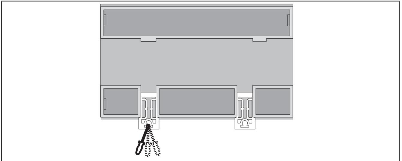
**Fig. 5.** Dettaglio dispositivi di aggancio a molla
