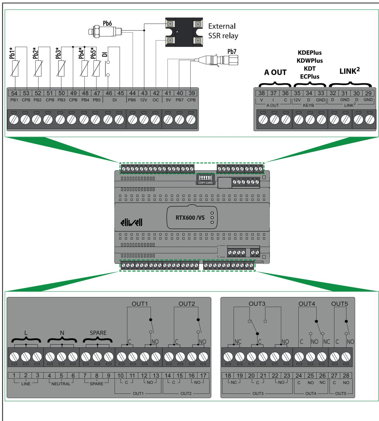
Fig. 32. Schema di cablaggio della scheda base
