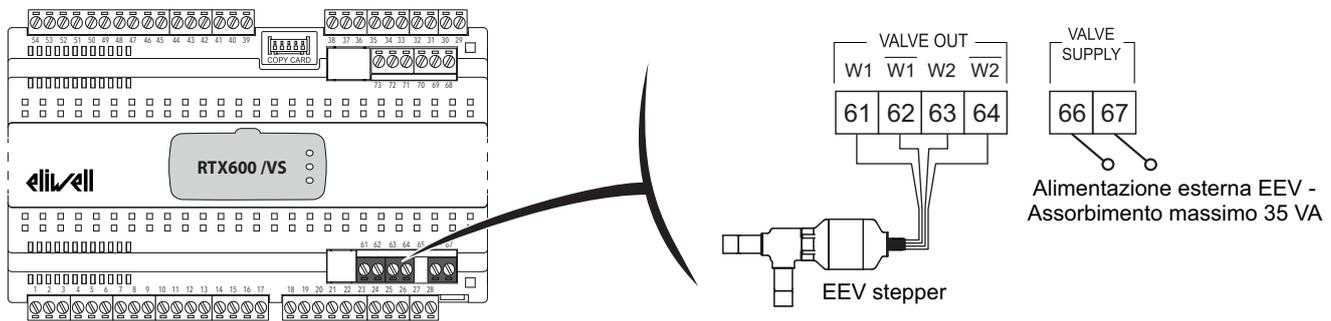
Prima di collegare la valvola, configurare accuratamente l' **RTX 600 /VS** selezionando il tipo di valvola dall'elenco delle valvole compatibili/pilotabili.
