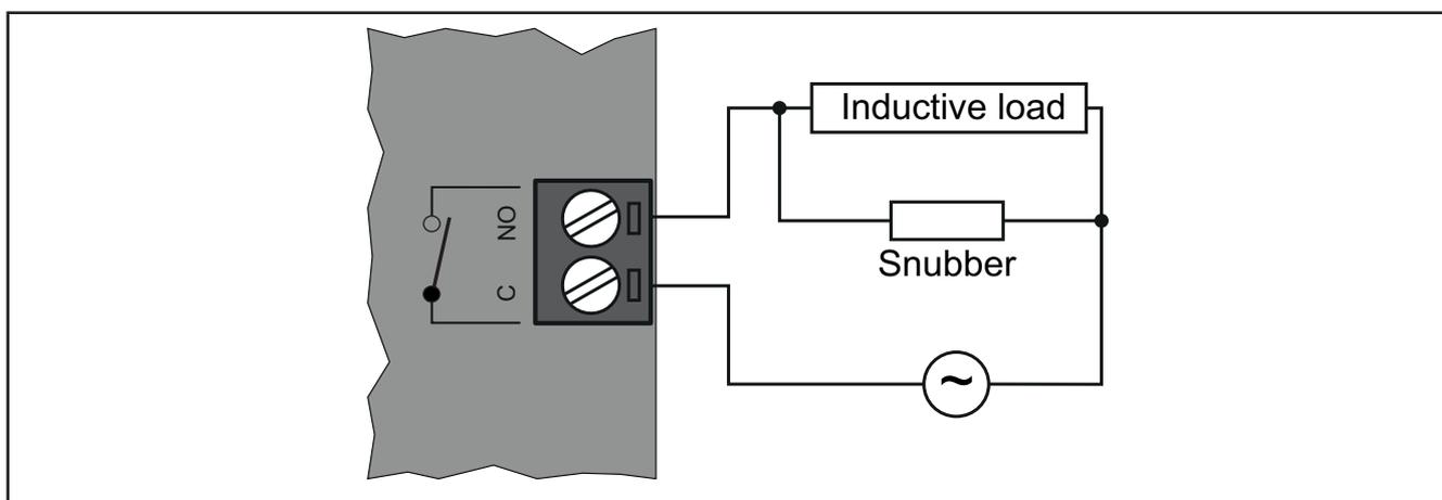
Fig. 28. Circuito di protezione A
