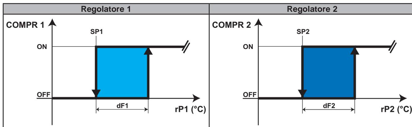
Il primo regolatore attua l'uscita **COMPR 1**, la quale dipende dalle grandezze e parametri indicati nello schema, oltre che dalle tempistiche di sicurezza compressore.
