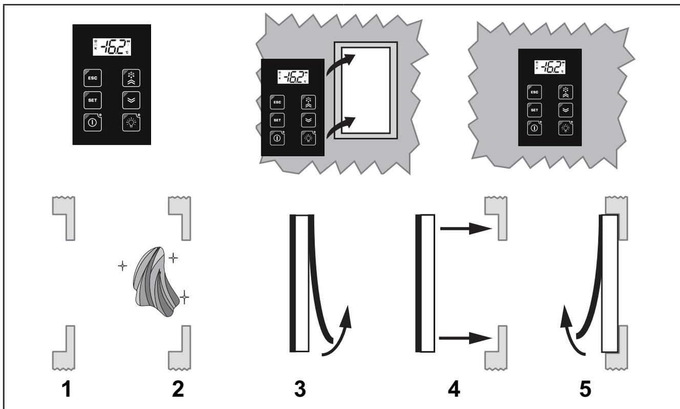
Fig. 17. Esempio di montaggio
