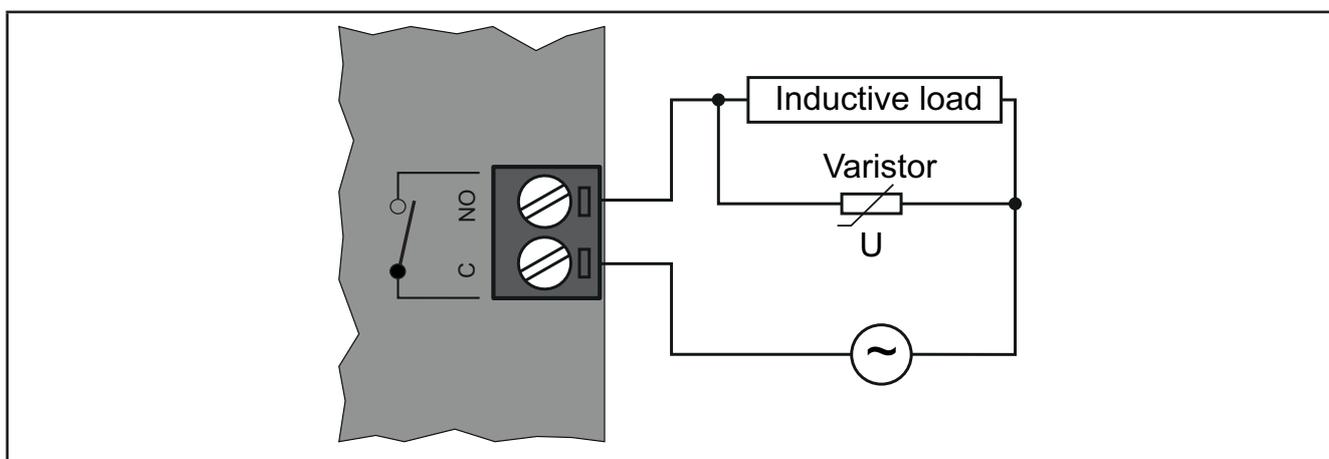
Fig. 29. Circuito di protezione B
