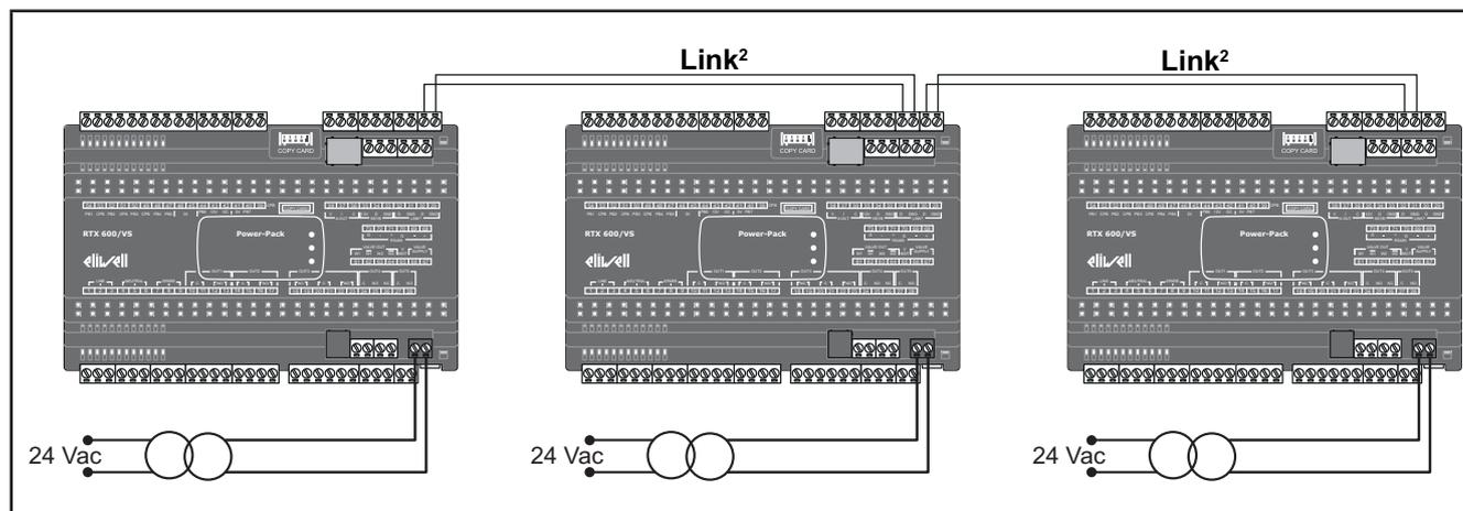
**Fig. 37.** Esempio di rete con linee di alimentazione separate
