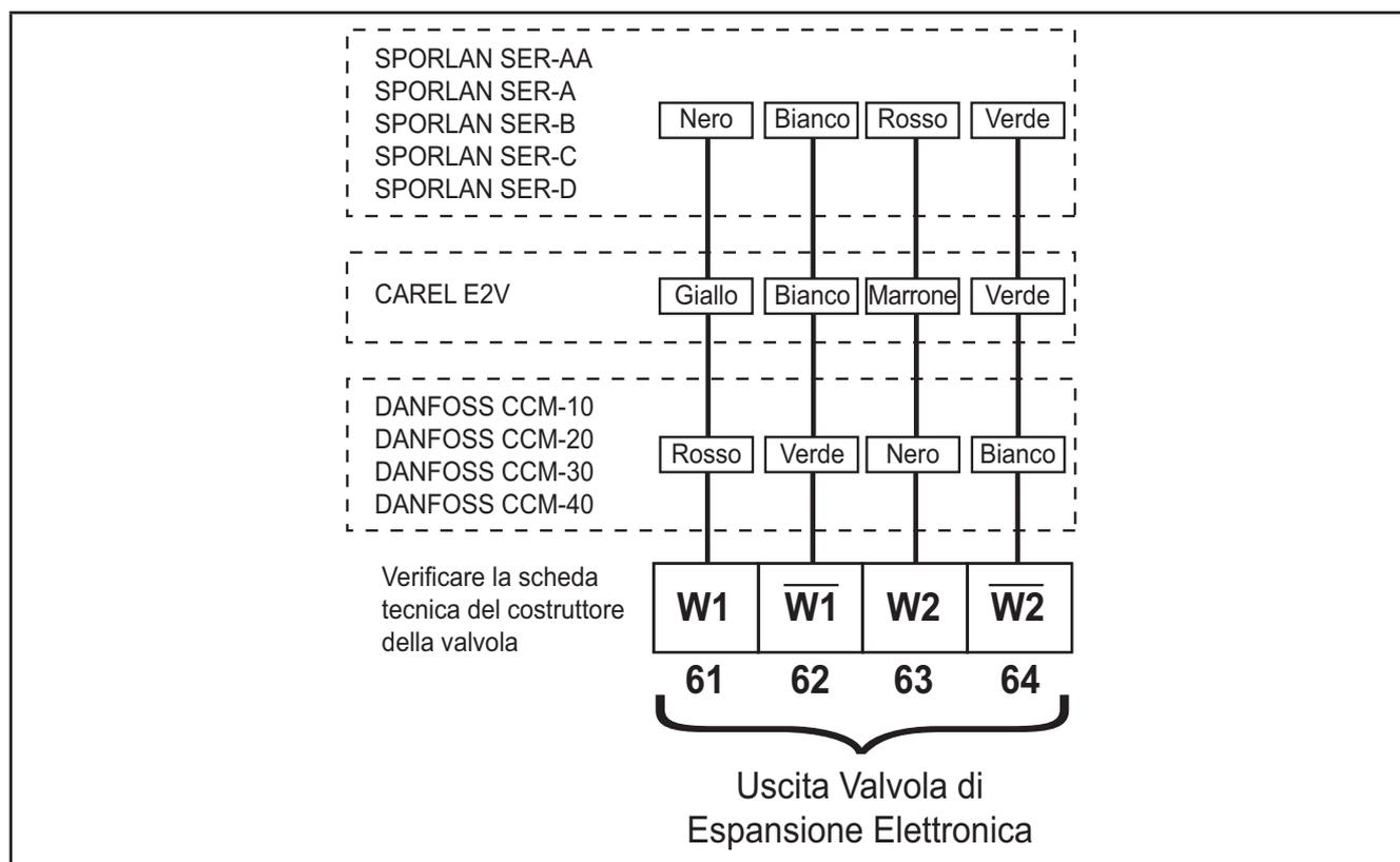
**Fig. 35.** Schema di connessione delle valvole stepper pilotabili
