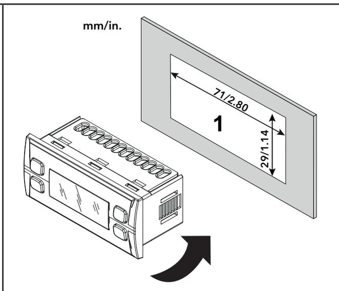
Fig. 8. Montaggio a pannello
