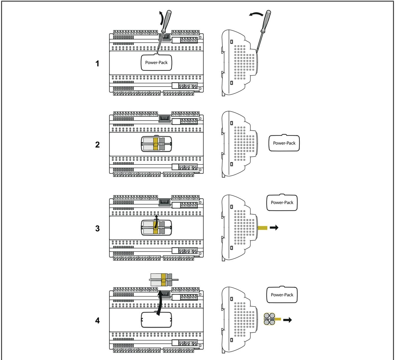
Fig. 25. Smontaggio del Power-Pack
