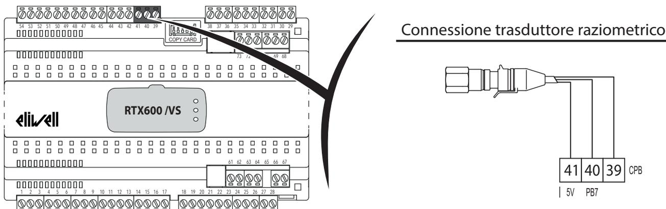
Per utilizzare l'ingresso raziometrico (Pb7) come sonda di saturazione, è necessario impostare il parametro **rSP** = Pb7. Mediante il parametro **trA** è possibile selezionare uno degli 8 preset, corrispondenti ai trasduttori raziometrici maggiormente usate:
