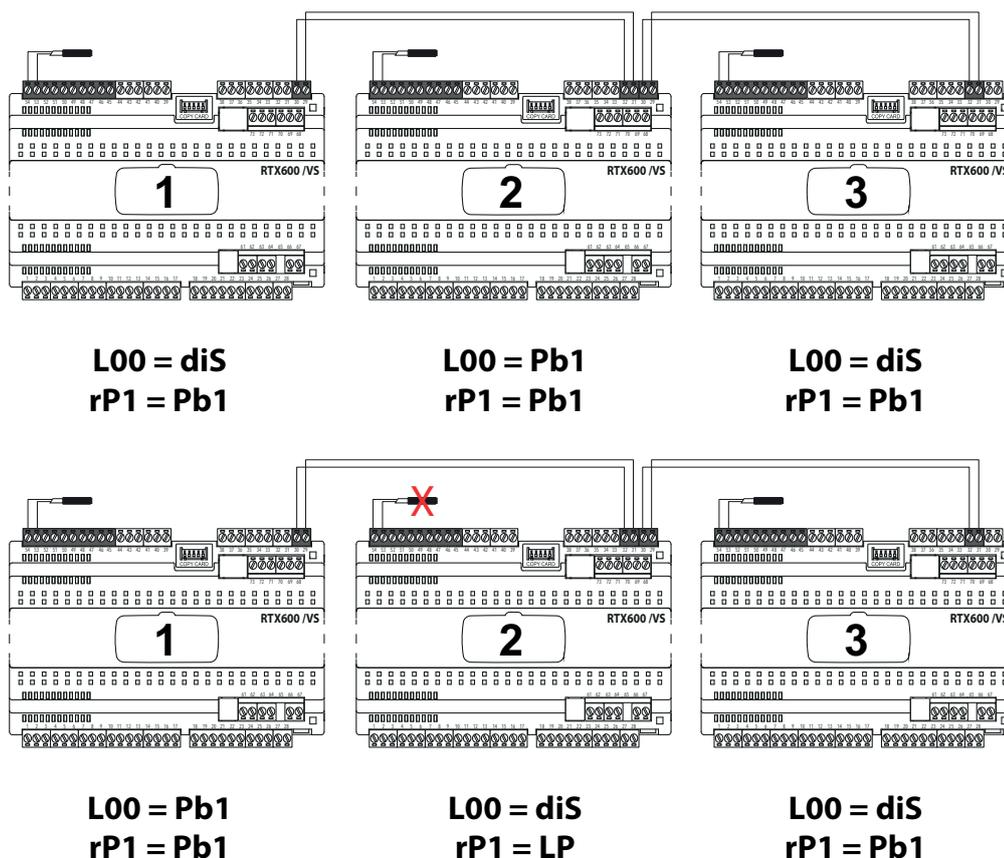
**NOTA:** La condivisione della sonda di temperatura, non vale solo per la regolazione, ma anche per altri regolatori (ventole evaporatore, resistenze riscaldanti, etc.).
