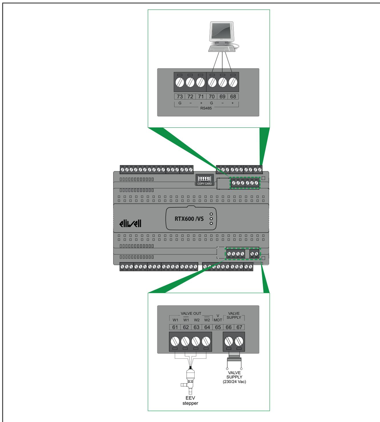
Fig. 33. Schema di cablaggio della scheda superiore
