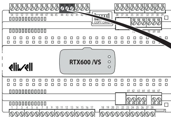
Connessione trasduttore di pressione
