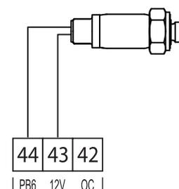
Per utilizzare l'ingresso 4..20 mA (Pb6) come sonda di saturazione, è necessario impostare il parametro **rSP** = Pb6. Mediante i parametri **H03** e **H04** è possibile impostare il limite inferiore (a 4 mA) ed il limite superiore (a 20 mA).
