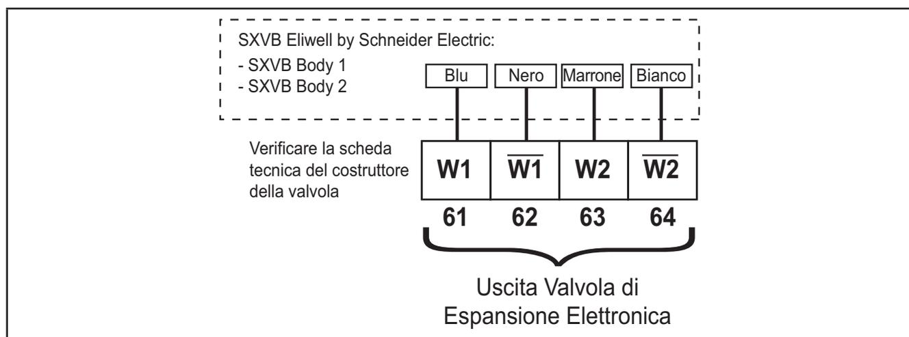
**Fig. 34.** Schema di connessione delle valvole stepper compatibile
