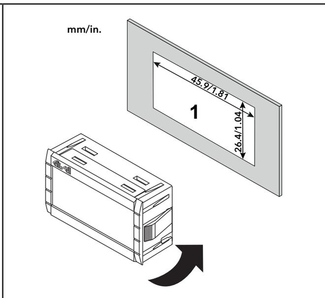
Fig. 22. Montaggio a pannello
