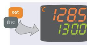
4 При нажатии **Set** или по истечении 15 секундной задержки произойдет возвращение к исходному дисплею
