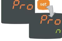
При индикации метки желаемой папки нажмите **set** для открытия соответствующей папки.
