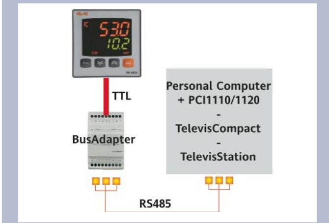
Der Anschluss an die Fernsteuerungssysteme Televis kann über den seriellen Port TTL (unter Verwendung des Schnittstellenmoduls TTL- RS 485 BUS ADAPTER 130 oder 150) oder bei den Modellen, für die es vorgesehen ist (EW4822), über Direktanschluss RS485 erfolgen. Für die entsprechende Konfigurierung des Gerätes muss man die Registerkarte mit dem Label "Add" aufrufen und die Parameter "dEA" und "FAA" verwenden.
