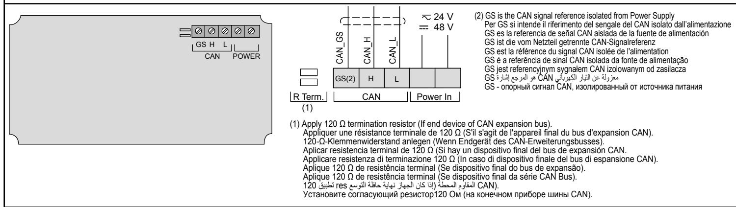
Pitch 3.81 mm (0.15 in.) or 3.50 mm (0.14 in.) / Passo 3,81 mm o 3,50 mm / Paso 3,81 mm o 3,50 mm / Abstand 3,81 mm oder 3,50 mm / Pas de 3,81 mm ou 3,50 mm / Passagem 3,81 mm ou 3,50 mm / Skok 3,81 mm lub 3,50 mm / مرحلة 3,81 ملم أو 3,50 ملم / Шаг 3,81 мм или 3,50 мм
