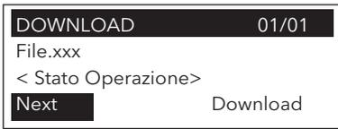
Il menu Download consente di 'scaricare' sullo strumento vari tipi di file - posizionandosi sulla voce Next e agendo sul tasto DX (right) si scorrono i vari tipi di file da scaricare<sup>[5]</sup>
