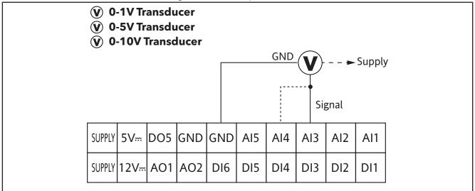
Fig. 28. Voltage input connection
