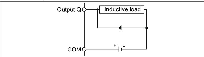
Fig. 19. Protective circuit B
