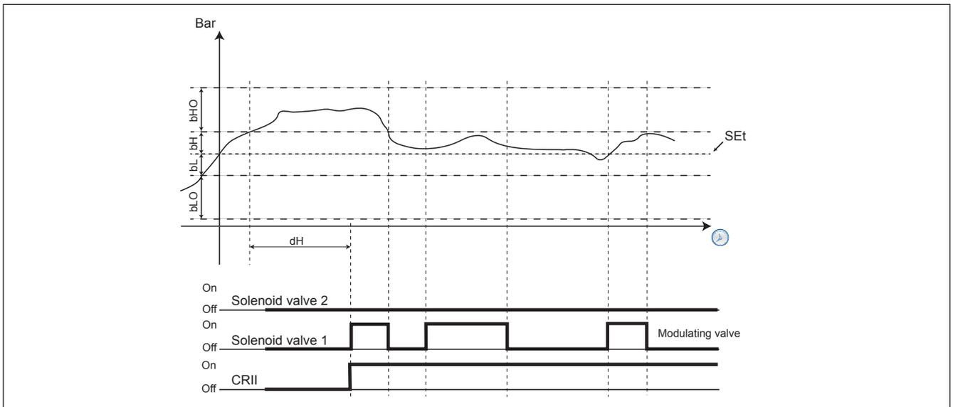
Fig. 30. CRII compressor on
