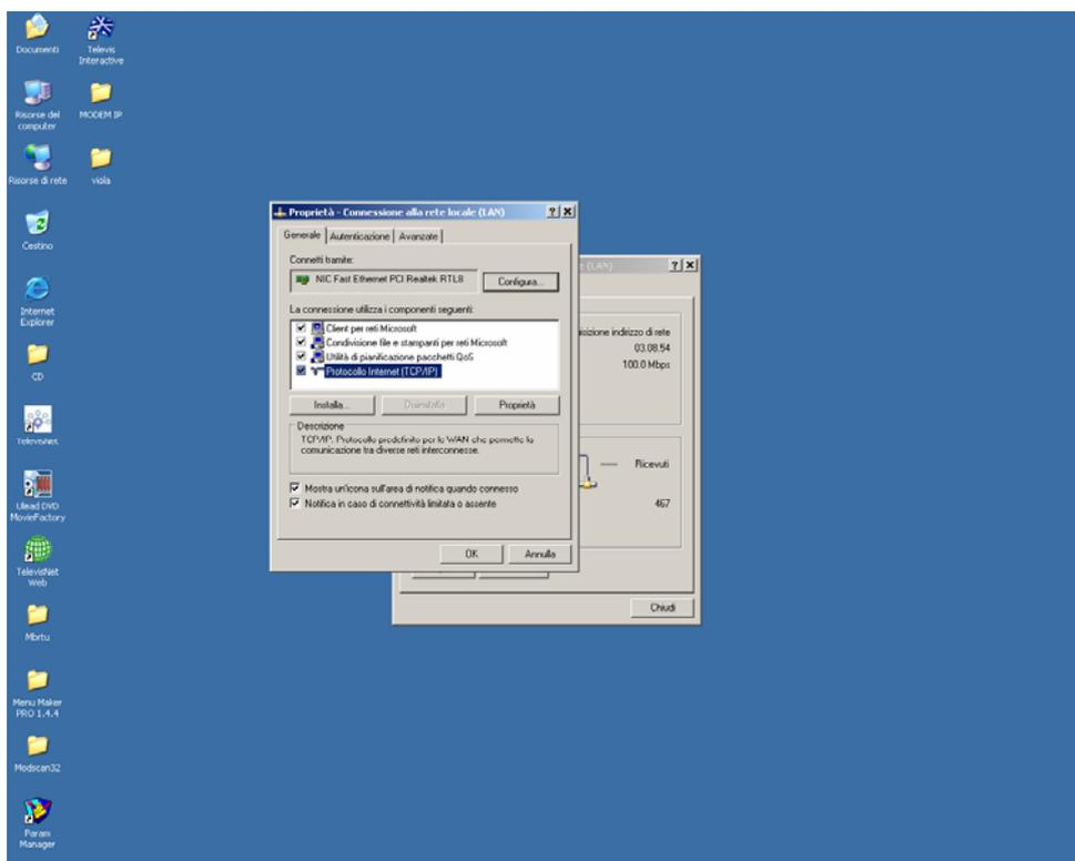
9. Impostare un indirizzo IP dello stesso gruppo di quello impostato nel Modem Viola ma assolutamente non uguale, impostare poi gli stessi valori di “Subnet mask” e “Gateway” impostati nel Modem Viola.
