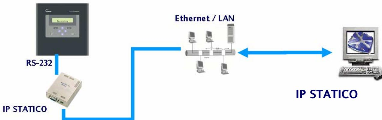
In questo tipo di connessioni il PC sul quale è installato il software di monitoraggio o supervisione deve avere un IP STATICO come anche il Modem Over IP.
