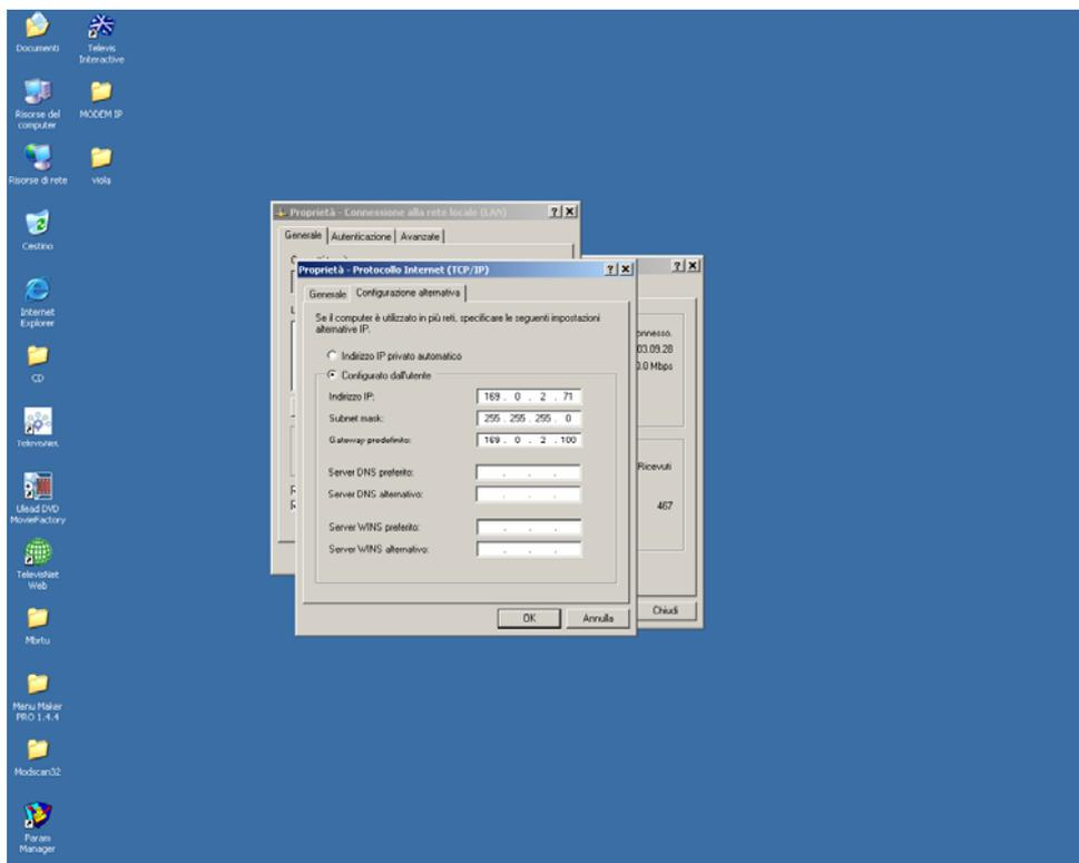
10. Collegare il Modem Viola al PC Interface tramite cavo seriale RS232, impostare nel Televis Compact il parametro PRESENZA MODEM a SI in /CONFIGURAZIONE/PARAMETRI CONFIG. , impostare il parametro VELOCITA' COM MODEM a 38400 in /CONFIGURAZIONE/PARAMETRI CONFIG in seguito spegnere e riaccendere il Televis Compact in modo che il modem Viola venga correttamente inizializzato. (Si faccia riferimento al Manuale Utente del Televis Compact)
