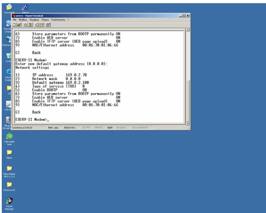
7. Scollegare il cavo seriale RS232 dal PC, riportare il dip n.4 a OFF e collegare il Modem Viola tramite cavo LAN incrociato o HUB al PC, aprire il pannello "Stato di Connessione alla rete Locale" e aprire proprietà.
