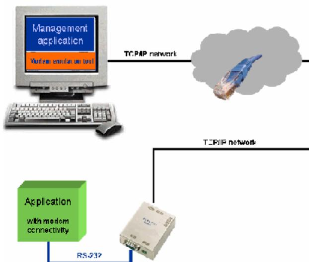
Ad esempio è possibile sostituire i modem standard o GSM in impianti di supervisione Televis e monitorare l'impianto da remoto utilizzando la rete LAN e non più la linea telefonica o la rete GSM.
