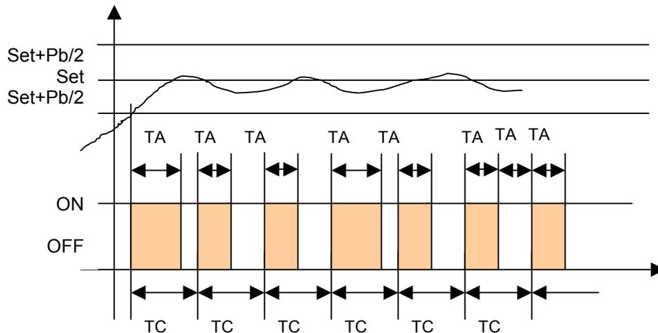
Come si deduce dal diagramma funzionale l'uscita del regolatore è molto più sollecitata rispetto alla regolazione on-off. Il controllo del carico tramite l'uscita del regolatore può essere:
